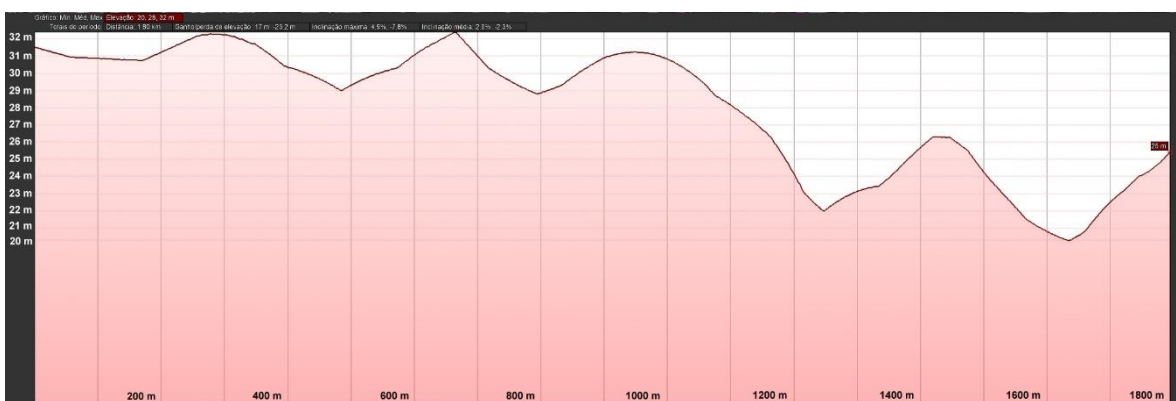
Figura 8 - Perfil planialtimétrico da adutora de água de reúso da EPAR-Polo Industrial (maior cota) até o ponto de entrega (menor cota)
