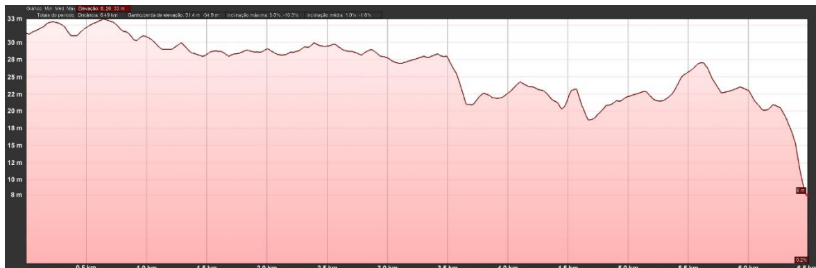
Figura 10 - Perfil planialtimétrico do emissário de concentrado da unidade de osmose reversa da EPAR – Polo Industrial (maior cota) até a Lagoa de Carapebus (menor cota)
