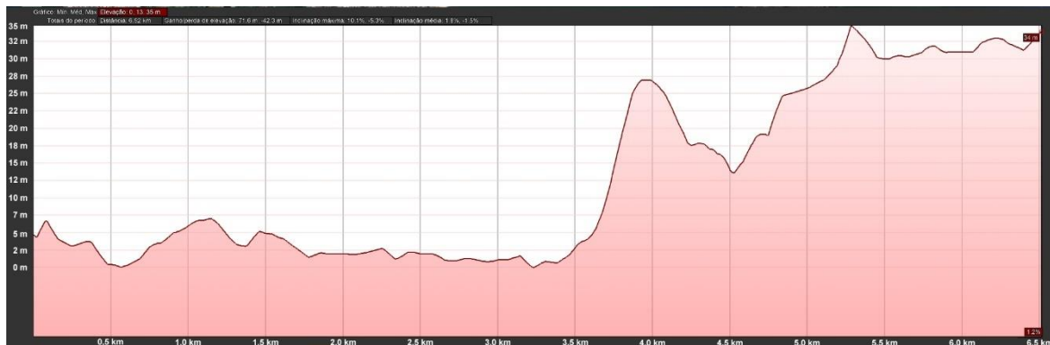
Figura 6 - Perfil planialtimétrico do emissário de esgotos da ETE Camburi (menor cota) até a EPAR-Polo Industrial (maior cota)
