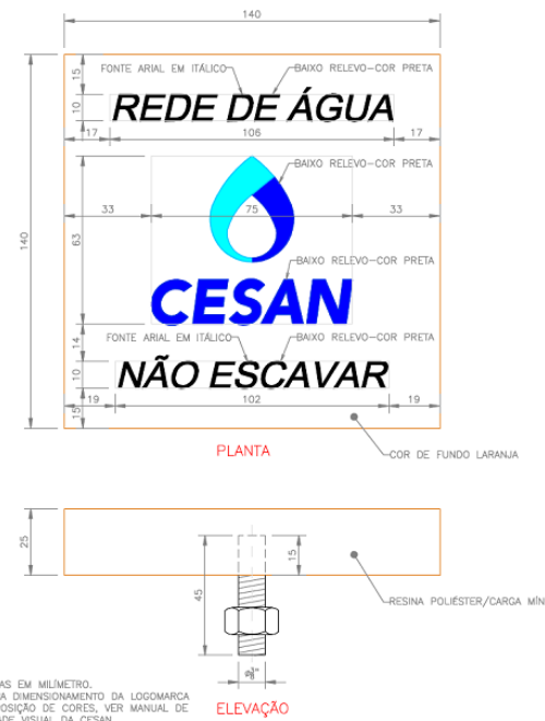
FIGURA A-3 - MARCO LOCALIZADOR DE TUBULAÇÃO TIPO TACHAO BIDIRECIONAL
